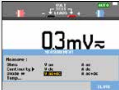
내장된 멀티미터는 편리한 정밀 측정을 제 공합니다.
