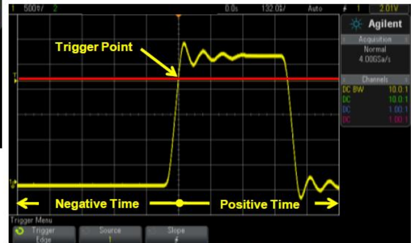
Trigger = Rising edge @ +2.01 V
