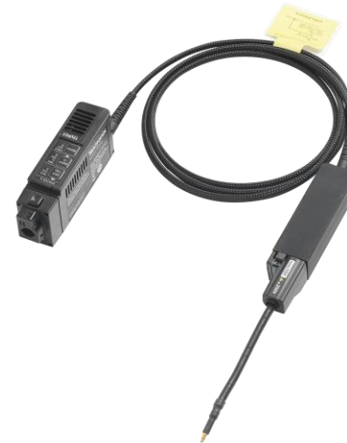
TIVP ( \pm 3300\text{V} , \leq 60\text{kV} , 1 GHz)
